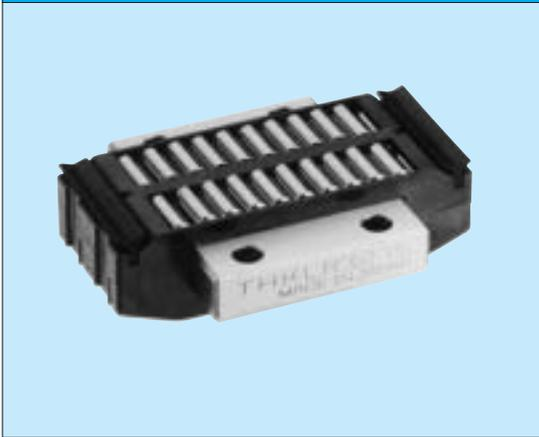
在安裝面加工溝槽，將 LM 輓子嵌入溝槽裏。LM 輓子的安裝方法是，利用軌道台上加工的 4 個孔用螺栓固定。適用於主機安裝部分厚度不充裕的地方。（也可使用安裝用配件 SM 型和 SE 型。）
