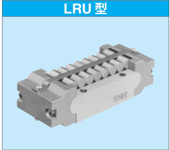
因不需要在安裝面上加工溝槽，所以能減少加工時間。安裝是通過軌道台上被加工了的4個孔，用安裝螺栓進行固定。
